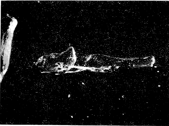
Abb. 8. Nadelförmig splitterartiges Elektrokorn 70fach
