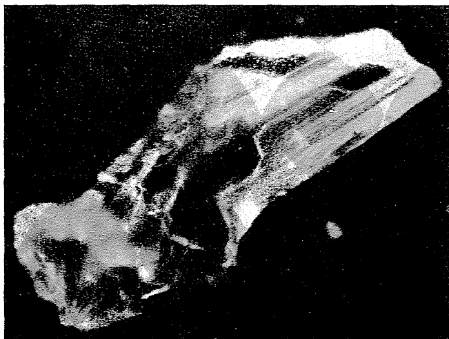
Abb. 4. Längliches Elektrokorkorn 130fach
